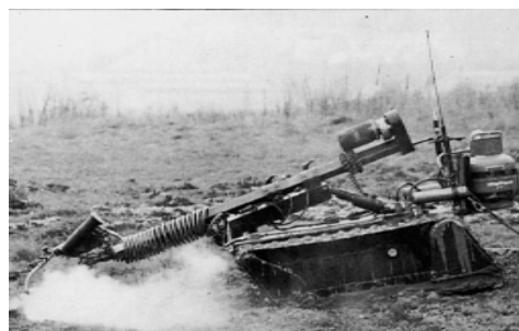
Рис. 2. Бойковый трал JSFU Mk3 инженерных частей Великобритании
